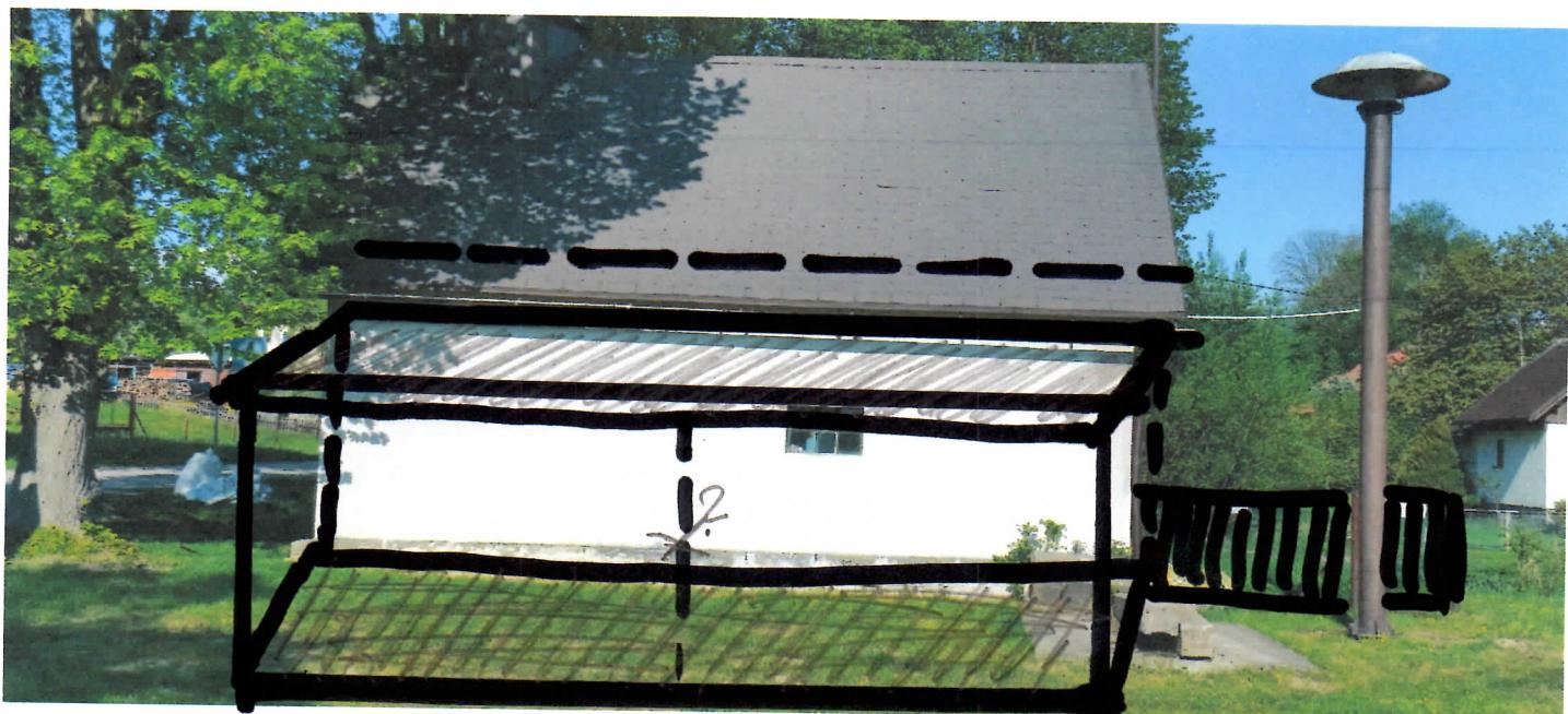
V „lepším případě“ má vyjít střecha pergoly pod střechu zbrojnice místo okapu, když to výškově, spádem vyjde..., má-li být pod pergolou plocha se zámkovou dlažbou..., v „ještě horším“ případě, když by spád nevyšel..., pak by se střecha pergoly napojovala na střechu zbrojnice nad stávající okap... = druhá čára
